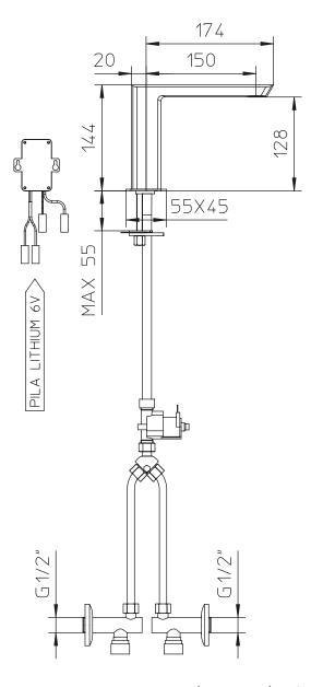
Attenzione: il rubinetto deve essere elettricamente isolato (messa a terra) per funzionare correttamente. Warning: the faucet must be electrically insulated from the earth to operate properly.
